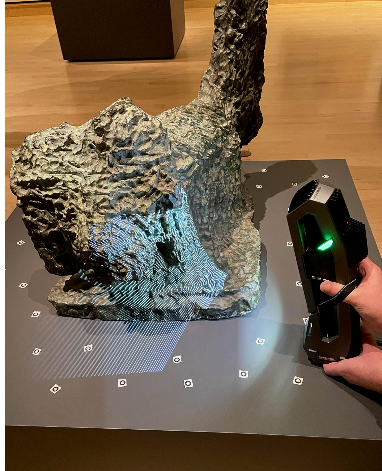
les techniques de numérisation 3D, les zones qui ne peuvent être captées par la triangulation des capteurs ou les appareils photo ne peuvent être représentées à l'écran. Cela crée des trous sur la surface de la modélisation 3D que l'on doit remplir à l'aide d'un logiciel de post-traitement, ou laisser tels quels, selon l'utilisation prévue du modèle 3D.
